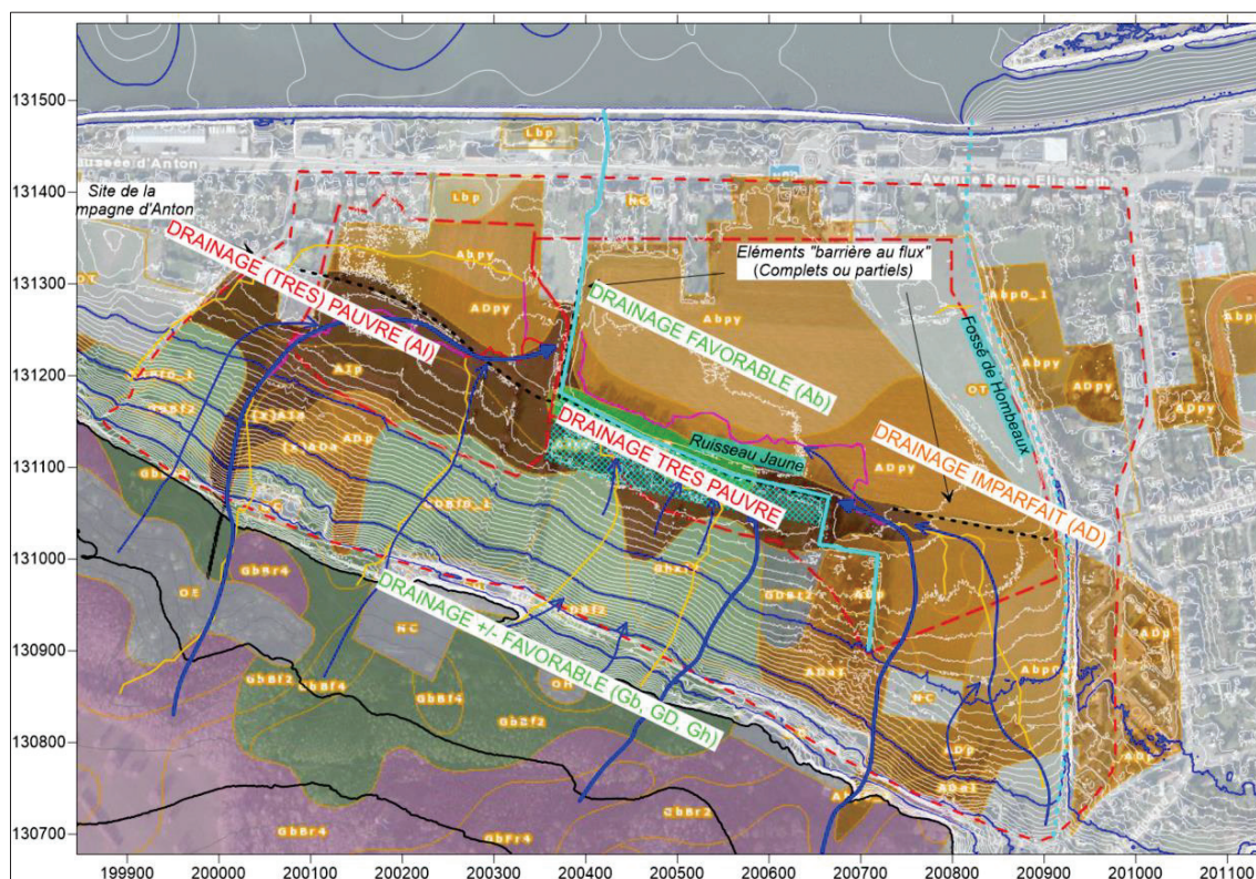
Figure 2-6 : Campagne d'Anton – Corrélation entre pédologie, topographie et flux principaux d'eau
